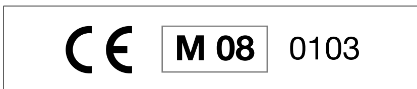
Abbildung 4: Kennzeichnung von Messgeräten, die der Richtlinie 2004/22/EG (MID) unterliegen (in Anlehnung [17])
